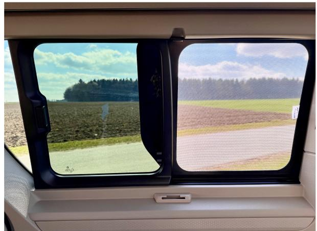
**Bei hohen Temperaturen im Fahrzeug kann sich das Fliegengitter ggf. leicht vorformen, dies legt sich im Normalfall beim Abkühlen des Materials wieder von alleine.**
