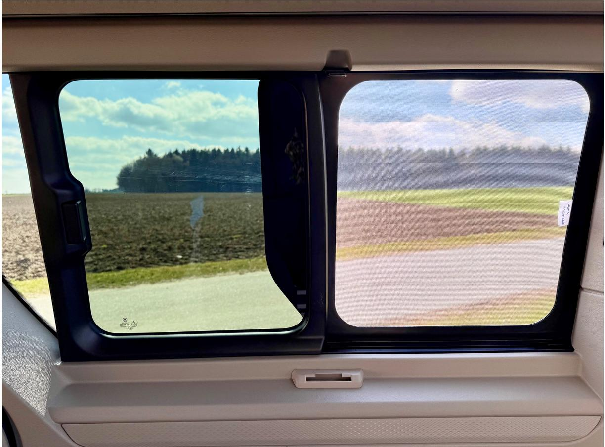
Das Fliegengitter kann durch die asymmetrische Form je nach Ausführung nur im rechten oder linken Schiebefenster verbaut werden. Das MAXXCAMP-Etikett muss nach vorne und in das Fahrzeuginnere ragen, während die ausgeschnittene Ecke sich im unteren und hinteren Teil des Fensters befindet.
